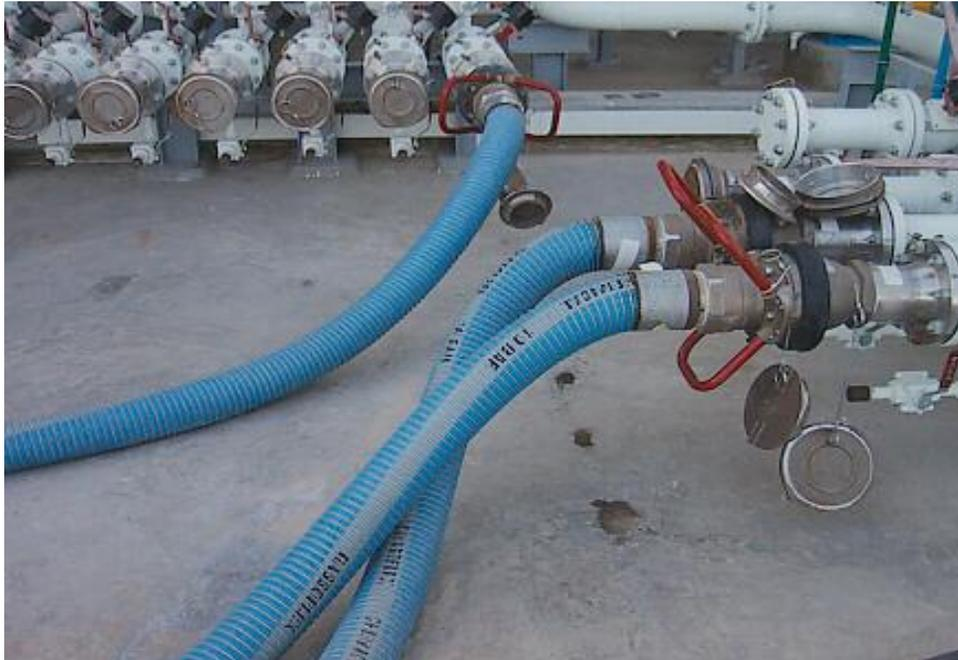
Рукава изготовлены из многослойной термопластиковой плёнки с двойным армированием: снаружи - спиралью из стальной проволоки, изнутри - кордом из различных материалов (в зависимости от сферы применения).
