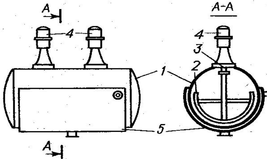
Горизонтальный аппарат с вертикальными мешалками для растворения расплава алкидов:
