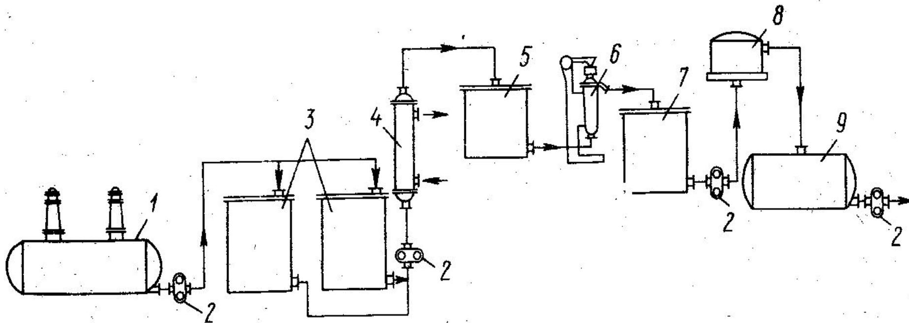
**Принципиальная. схема двухступенчатой очистки лаков:**
