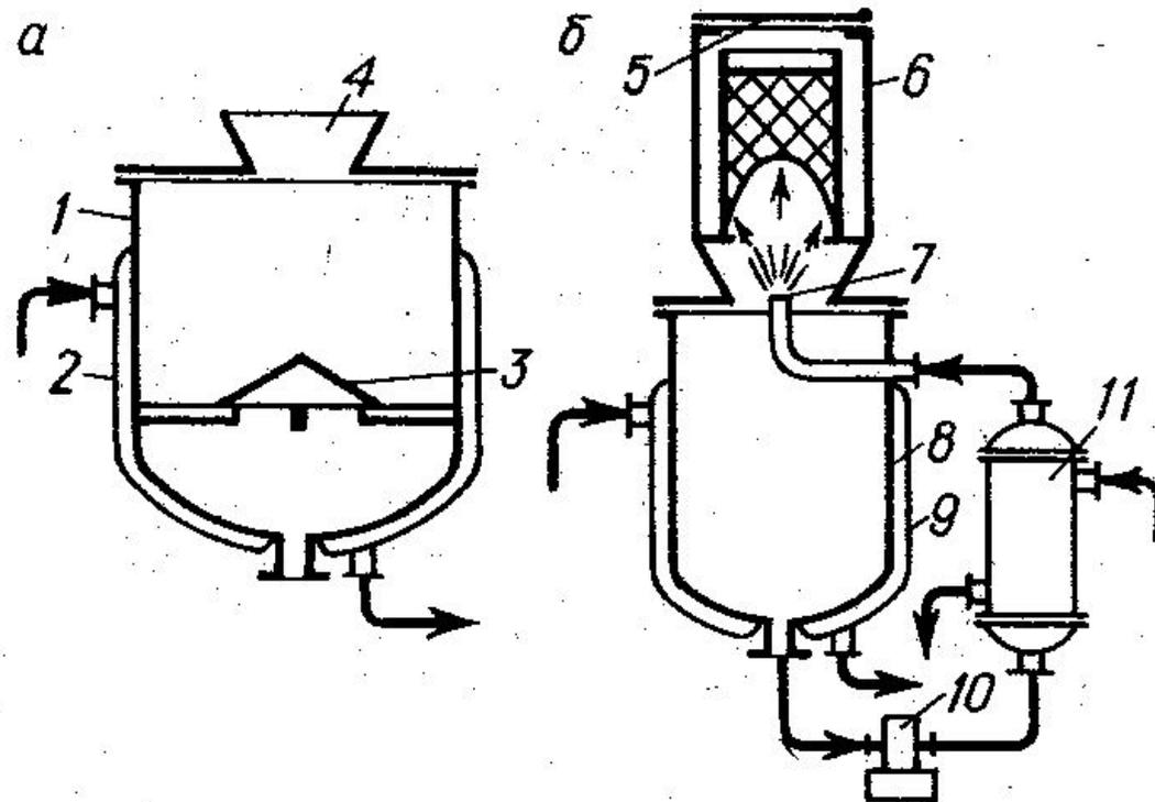
Аппараты для плавления кусковой и гранулированной (а) и монолитной в бочках (б) канифоли:
