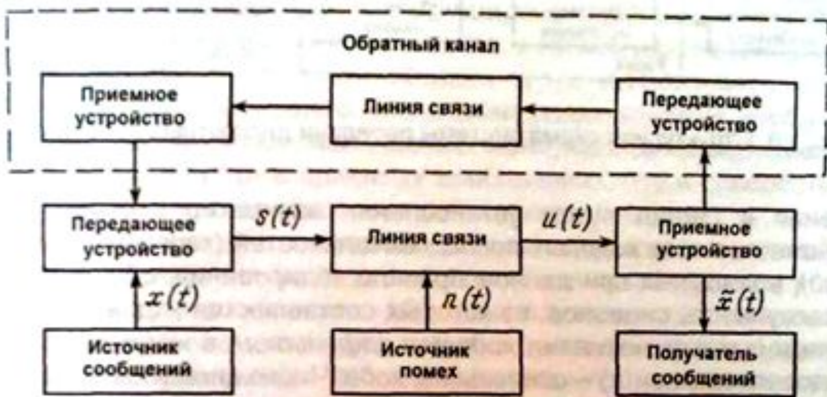
Структурная схема радиотехнической системы передачи информации
