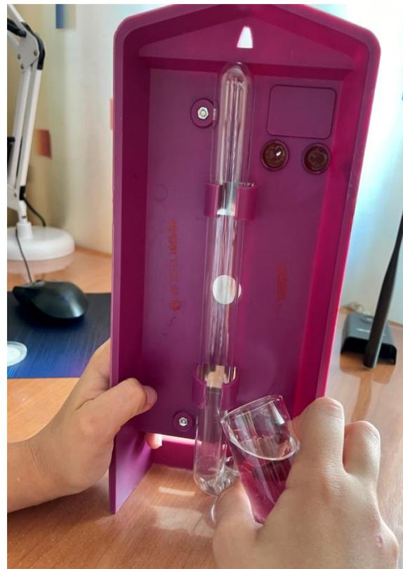
Рис.5 Гигрометр психрометрический ВИТ-1.
