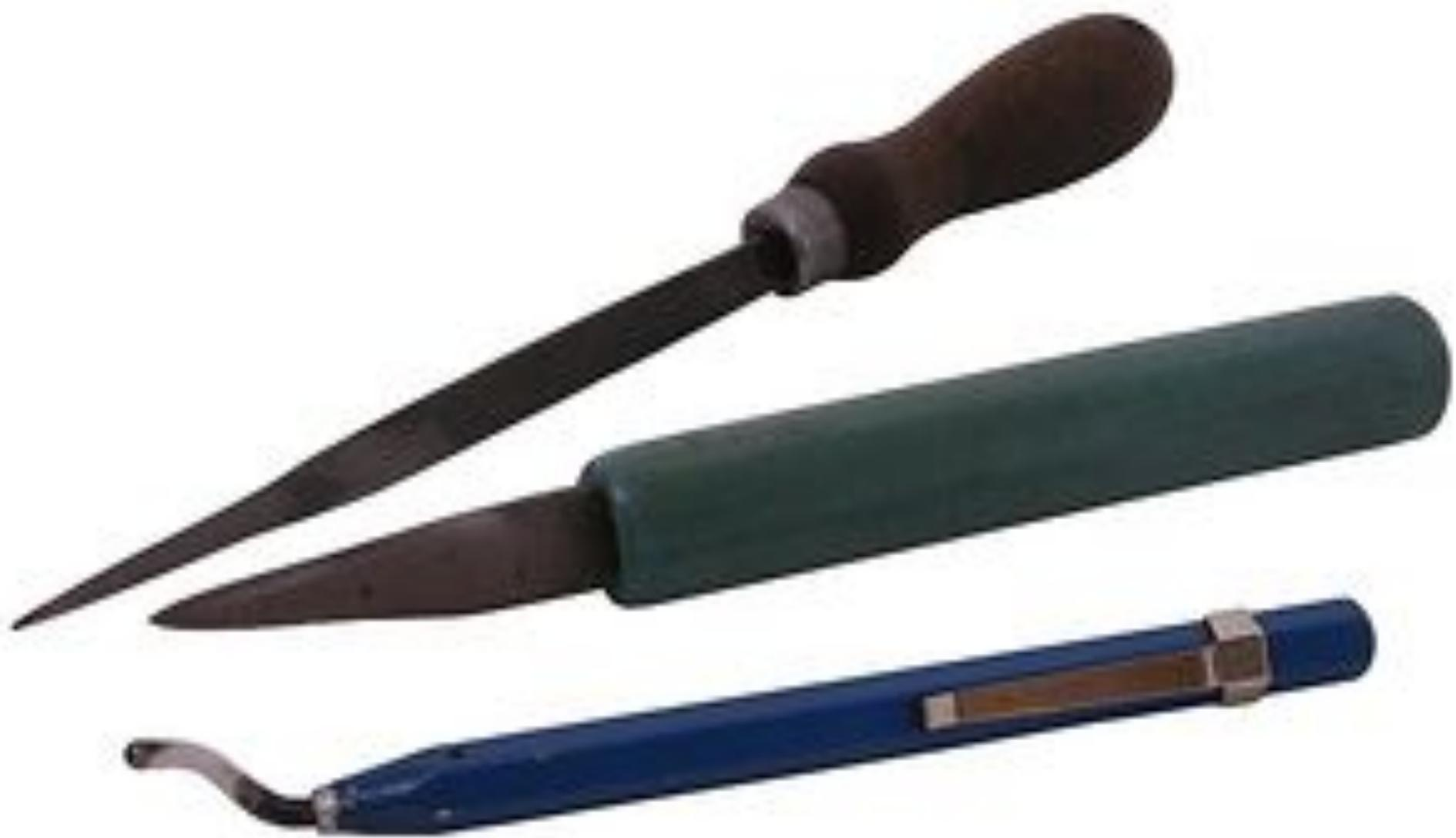
В переводе с немецкого ШАБЕР (schaber, schaben) означает **скоблить**. Этот слесарный инструмент с трёх или четырёхгранной рабочей поверхностью и чем-то напоминает напильник по металлу с заострённым концом и ручкой.
