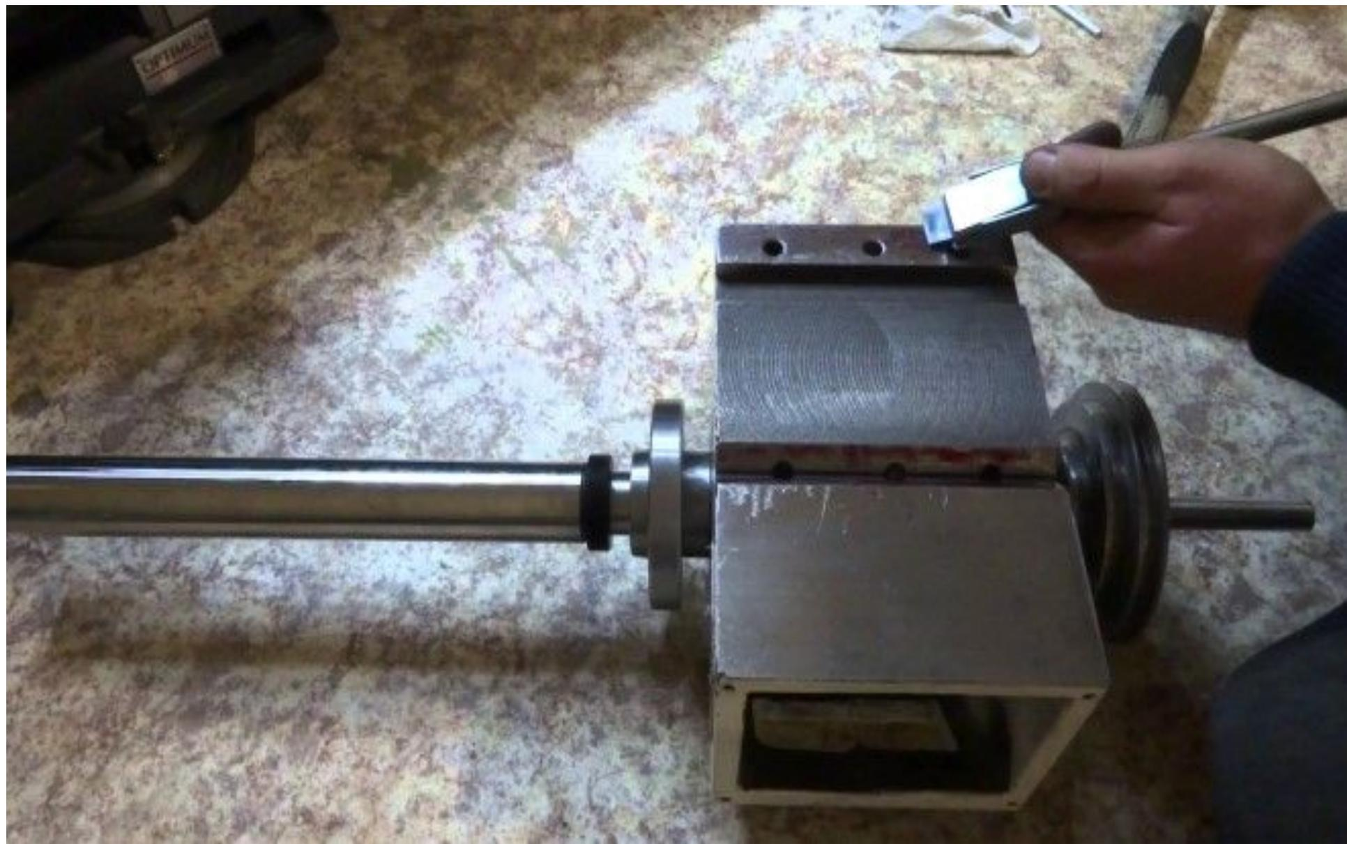
Инструменты для шабрения называются шаберами. Для изготовления шаберов используют инструментальные углеродистые стали У10, У10А, У12, У12А, легированную сталь Х05, а также твердосплавные пластины, вставляемые в стальные державки. Бывшие в употреблении и вышедшие из строя трехгранные или плоские напильники после соответствующего шлифования также могут использоваться в качестве шаберов.
