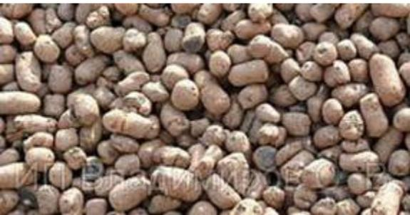
Аглопорит представляет собой искусственный пористый заполнитель с размером гранул 5-20 мм, насыпной плотностью 400-700 кг/м<sup>3</sup> и пределом прочности 0,4-1,5 МПа. Сырьем для производства аглопорита служат глинистые породы (суглинок, супесь, аргиллит, глинистый сланец), а также отходы промышленности - глинистые отходы от добычи и обогащения углей, горелая порода, топливные шлаки, зола ТЭЦ и др.
