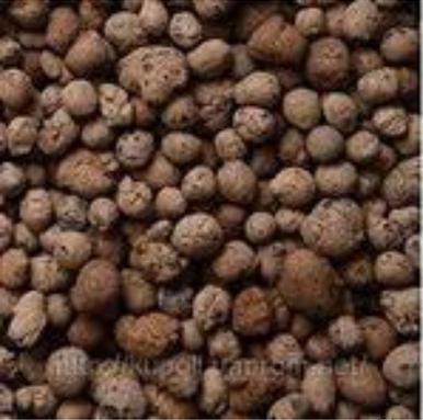
а) *керамзит* и его разновидности, шунгизит, зольный гравий, глинозольный керамзит, вспученные азерит, получаемые обжигом со вспучиванием подготовленных гранул (зерен) из глинистых и песчано-глинистых пород (глин, суглинков, аргиллита, алевролита), трепелов, шунгизитосодержащих сланцев, золошлаковой смеси или золы-уноса ТЭЦ,
