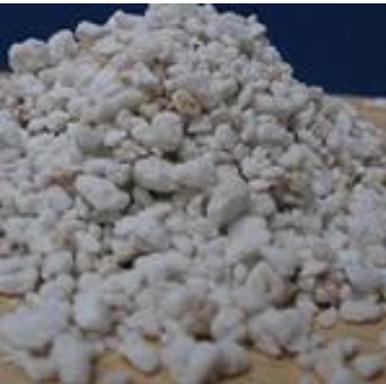
б) *тремолит*, получаемый при обжиге без вспучивания щебня или подготовленных гранул кремнистых опаловых пор (диатомита, трепела, опоки и др.);
