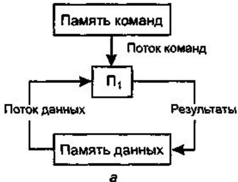
**МКОД (MISD)** — множественный поток команд — одиночный поток данных, предполагает построение своеобразного процессорного конвейера, в котором результаты обработки передаются от одного процессора к другому по цепочке.
