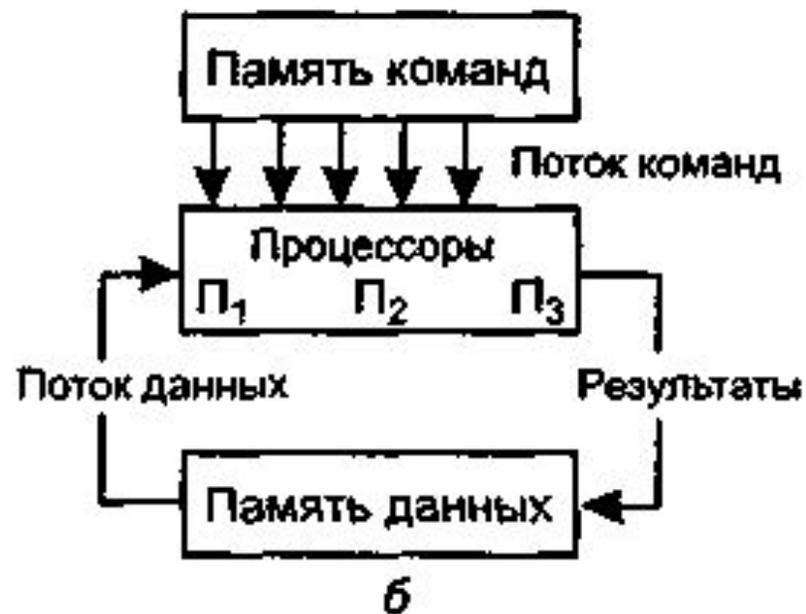
**ОКМД (SIMD)** — одиночный поток команд множественный поток данных, предполагает создание структур векторной или матричной обработки.
