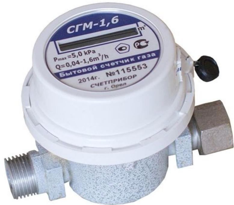
Максимальный поток (объём газа, проходящий за единицу времени) легко подсчитать путём сложения соответствующих показателей, указанных в паспортах ваших газовых установок (плиты, газового котла и т. д.). Далее следует добавить запас (порядка 20-25%), чтобы счётчик не работал на грани своих возможностей.
