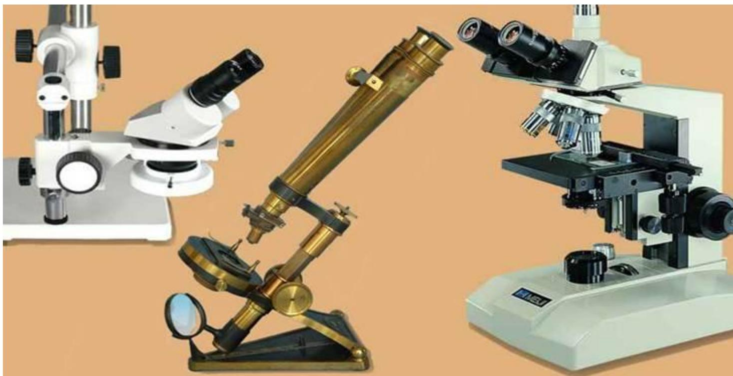
Световой микроскоп — сложный оптический прибор, позволяющий увеличивать изображение объекта в **1500—2000** раз.
