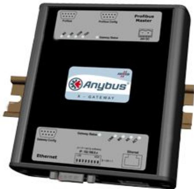
**Шлюз (*gateway*)** – служит для соединения сетей с разными протоколами (сеть персональных компьютеров и аппаратура).
