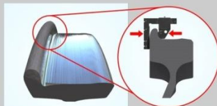
Вертикальный подрез гребня
