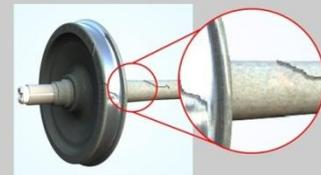
Следы контакта с электродом в любой части колесной пары
