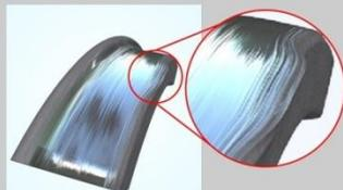
Кольцевые выработки на поверхности катания
