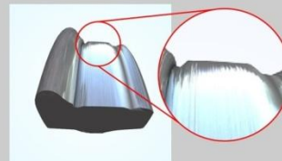
Кольцевые выработки на поверхности катания
