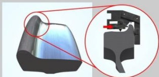
Изменение толщины гребня (тонкий гребень)
