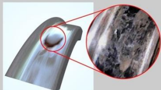
Навар на поверхности катания колеса
