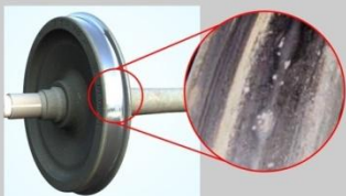
Следы контакта с электродом в любой части колесной пары
