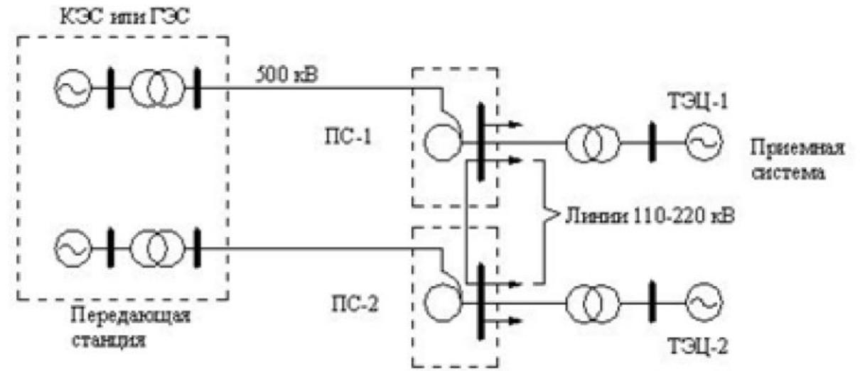
3. В связанной схеме, **обеспечивающей большую надежность** электроснабжения, многоцепная дальняя ЛЭП имеет вдоль своей трассы несколько соединений – переключательных пунктов – между отдельными цепями, делящими длинную линию на короткие участки.
