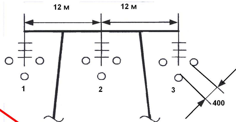
**Индуктивное сопротивление** обусловлено магнитным полем, возникающим вокруг и внутри проводов и жил кабелей, которое наводит в каждом проводнике электродвижущую силу самоиндукции.
