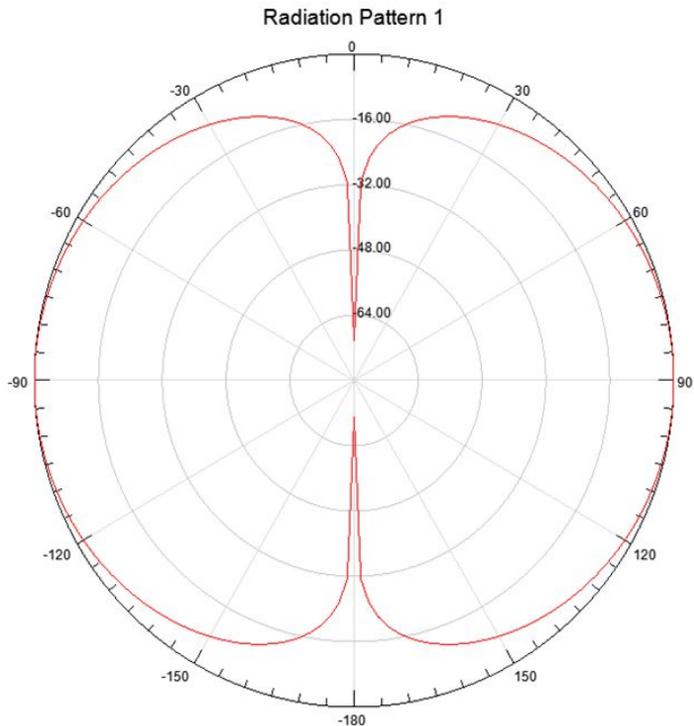
Если отношение длины вибратора и длины волны  $4L/\lambda=2$ , что соответствует увеличению частоты колебаний в 2 раза, то диаграмма направленности становится более "плоской" в вертикальной плоскости и как следствие имеет более высокий коэффициент усиления (примерно в 1.5 раза)
