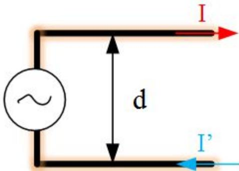
Излучение будет отсутствовать за счет того, что токи  $I$  и  $I'$  находятся в противофазе, что приводит их к взаимной компенсации. Для получения излучения можно развести концы двухпроводной линии, чтобы поля от токов  $I$ ,  $I'$  не могла компенсировать друг друга
