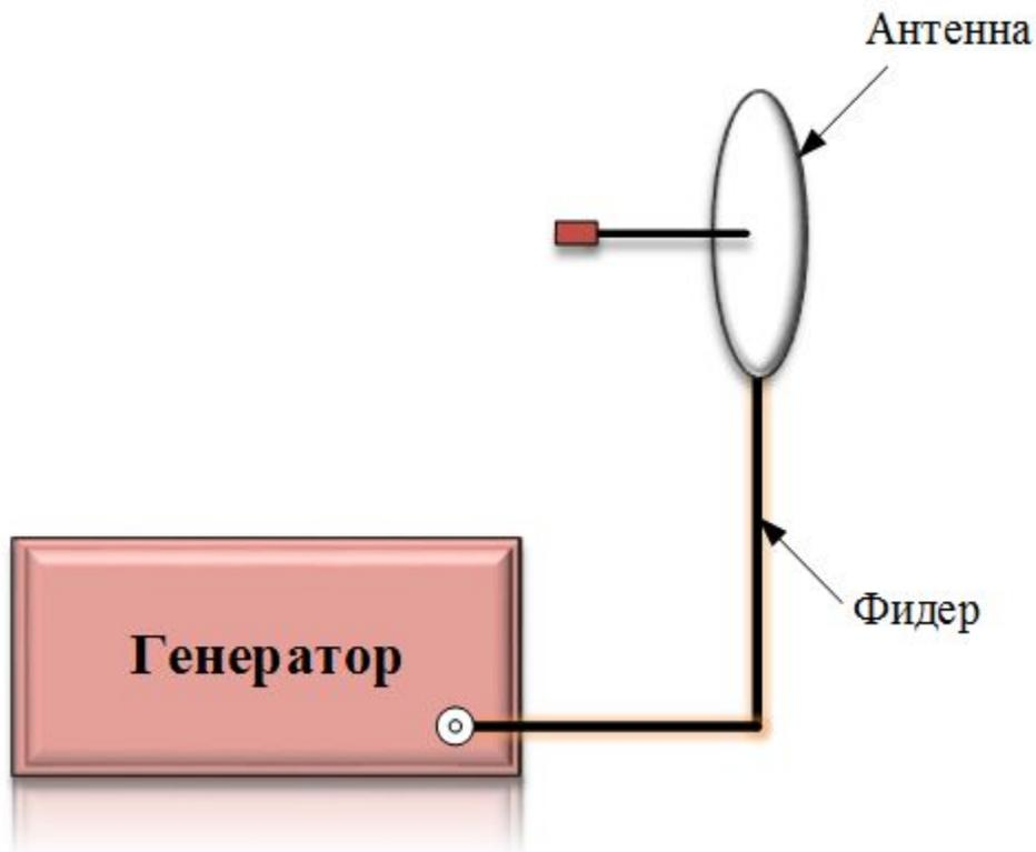
Любая антенна обладает так называемым принципом "двойственности", который говорит о том, что любая антенна может быть как передающей (то есть преобразовывать волны линии передачи в расходящиеся волны окружающего пространства), так и приемной (осуществлять обратное преобразование).
