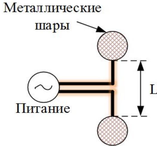
Такой излучатель можно сделать, если на концах тонких проводов (длиной  $L$ , меньшей длины волны) установить проводящие тела с большой емкостью (например, металлические шары). Заряженные шары создают токи, которые значительно выше емкостных токов между проводами. Так обеспечивается равномерное распределение тока вдоль проводника. Отметим, что на практике диполь Герца практически не используется
