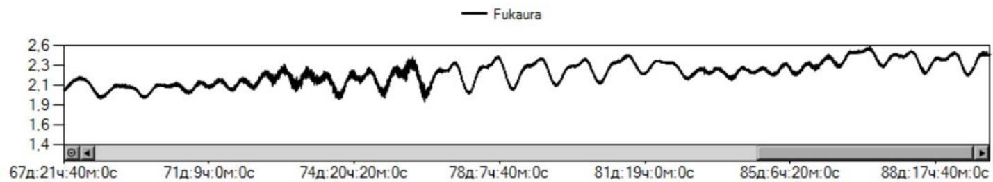
Как мы видим, на всех осциллограммах видны приливные колебания, но так же, очень хорошо прослеживаются гораздо более низкочастотные сейшовые колебания, с периодом примерно в 10 дней, что приблизительно соответствует частоте колебаний в  $e^{-5}$  Гц. На спектре мы как раз можем увидеть пики частот на этих значениях.
