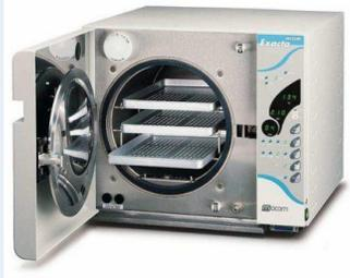
Для проведения стерилизации приготовленных питательных сред. Проводится обеззараживание исследуемого материала при помощи пара
