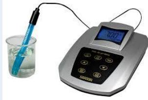
Прибор для определения реакции питательной среды. Для роста различных видов микробов требуется определенная реакция среды в пределах от 6, 8 до 8, 0
