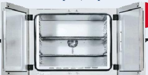
Прибор для проведения воздушной стерилизации. Для стерилизации стеклянной лабораторной посуды (чашки Петри, пробирки, пипетки и др.)                                                             |
