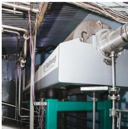
Мы первые разработали и применили технологию декантирования (отделения твёрдой фракции от жидкости) в производстве пива.
