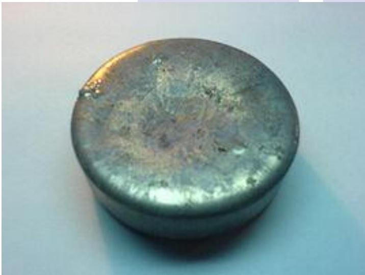
**Свинец** мягкий ковкий синевато-серый металл. Используемый для пластин аккумуляторов (основная масса металла), в сернокислом производстве – для коррозионностойкой химической аппаратуры, для оболочек электрических кабелей, защиты от радиоактивных излучений, в производстве антидetonаторов бензина, красок (красных – сурик, желтых – глет, белил).
