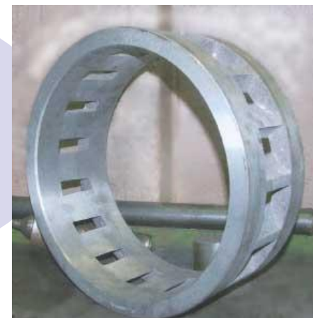
Износостойкий чугун (роторный измельчитель)
