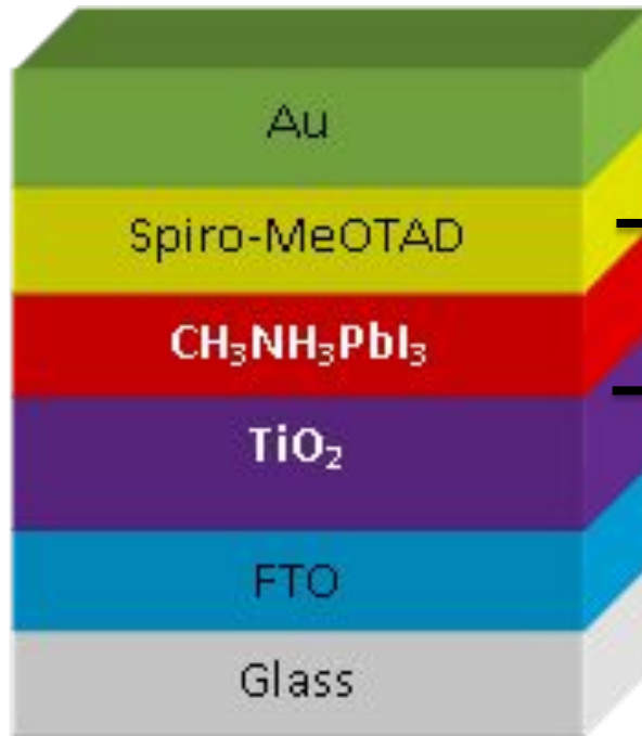
Рис.5. Структура ГОНП ФЭП
