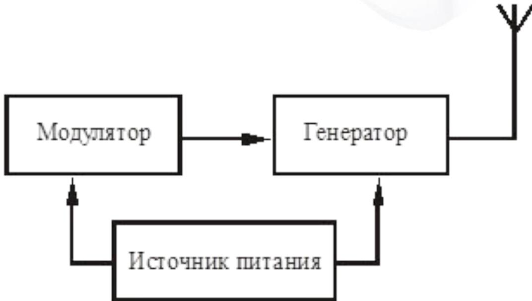
В такой схеме генератор является одновременно и источником высокочастотных колебаний, и каскадом, обеспечивающим необходимую мощность, а также совместно с модулятором образует модуляционный каскад. По такой схеме стоятся, например, передатчики помех. Основной недостаток таких схем – относительная низкая стабильность высокочастотных колебаний. Причина этого – непосредственная связь антенно-фидерной системы с генератором.
