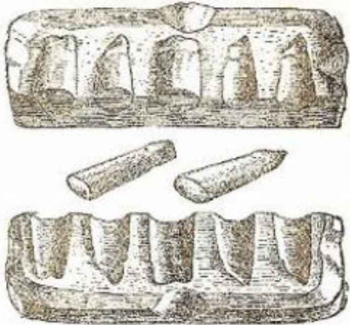
Гипсовый блок для получения металлических штам- пов.
