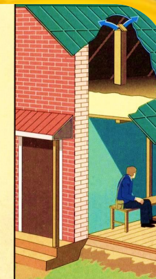
Помещение в здании, приспособленное под противорадиационное укрытие
