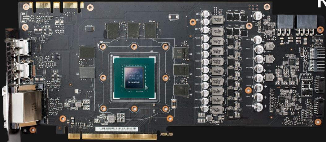
Графический процессор, GPU. Является основой видеокарты, отвечает за вычислительные функции, связанные с обработкой трёхмерной графики, тем самым высвобождает ресурсы центрального процессора. Именно от графического процессора зависит производительность видеокарты.
