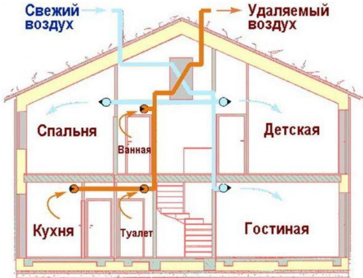
Клапаны приточной вентиляции «Овен» передают тепло приточному воздуху от системы отопления здания, к которой они подключены
