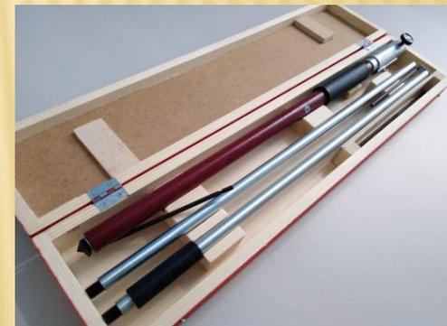
Линейка для проверки схождения управляемых колес.
