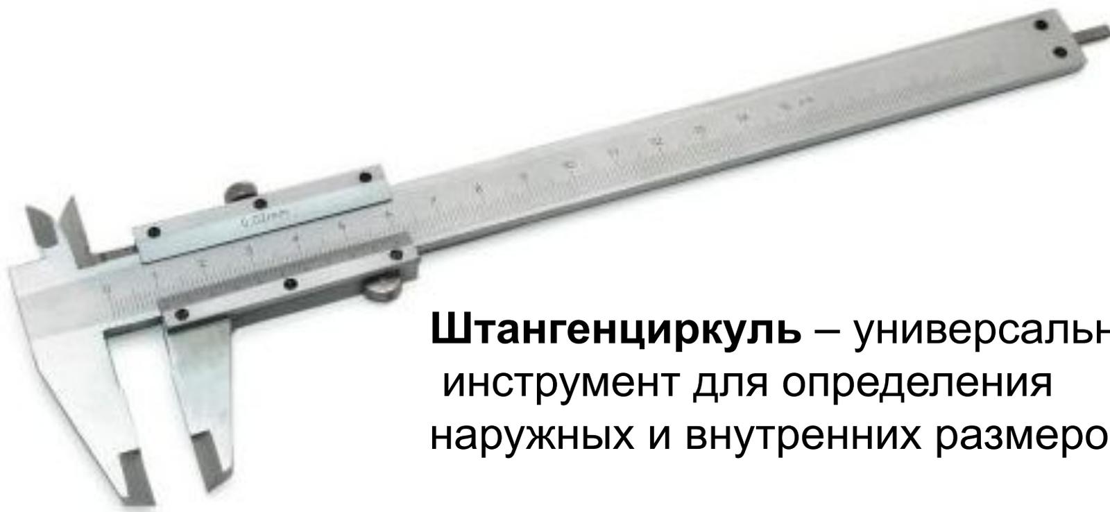
**Штангенциркуль** – универсальный инструмент для определения наружных и внутренних размеров
