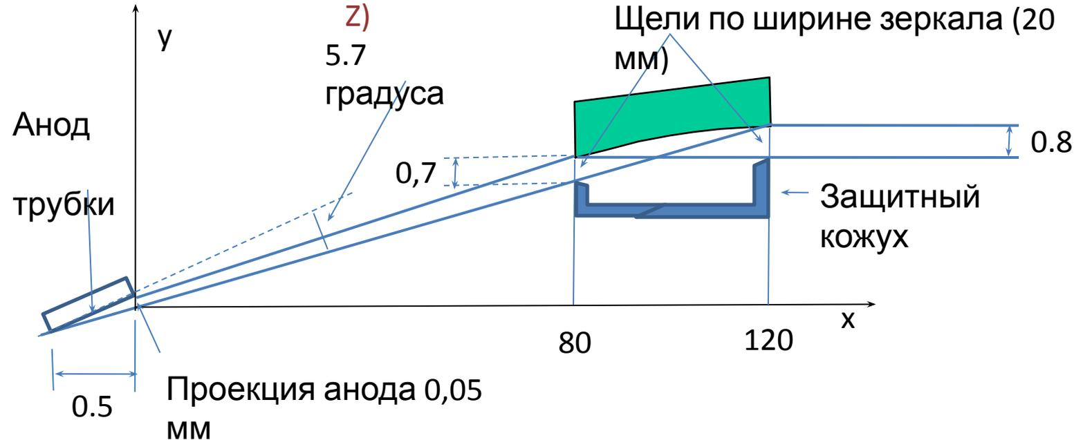
1. Трубка должна иметь возможность перемещения по оси  $y$  и вращения вокруг оси  $z$ .
