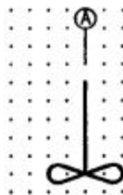
Propellerrührer (Propeller agitator)
