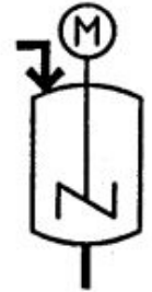
Behälter mit Rührer, Antrieb durch Elektromotor (Vessel with agitator driven by electric motor)
