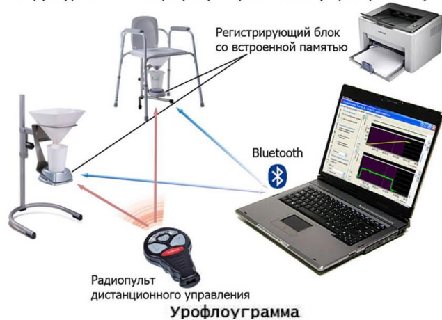
Структурная схема Урофлоуметра УФМ-24 ("Урострим-24")
