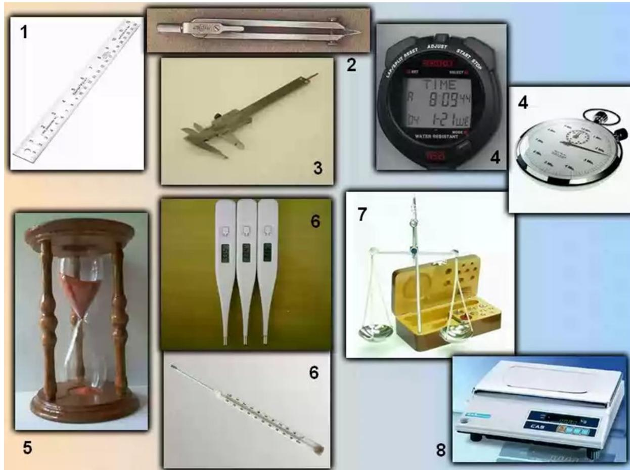
1 — линейка; 2 — измеритель; 3 — штанген—циркуль; 4 — секундомер; 5 — песочные часы; 6 — термометр; 7 — аптечные весы; 8 — электронные весы.
