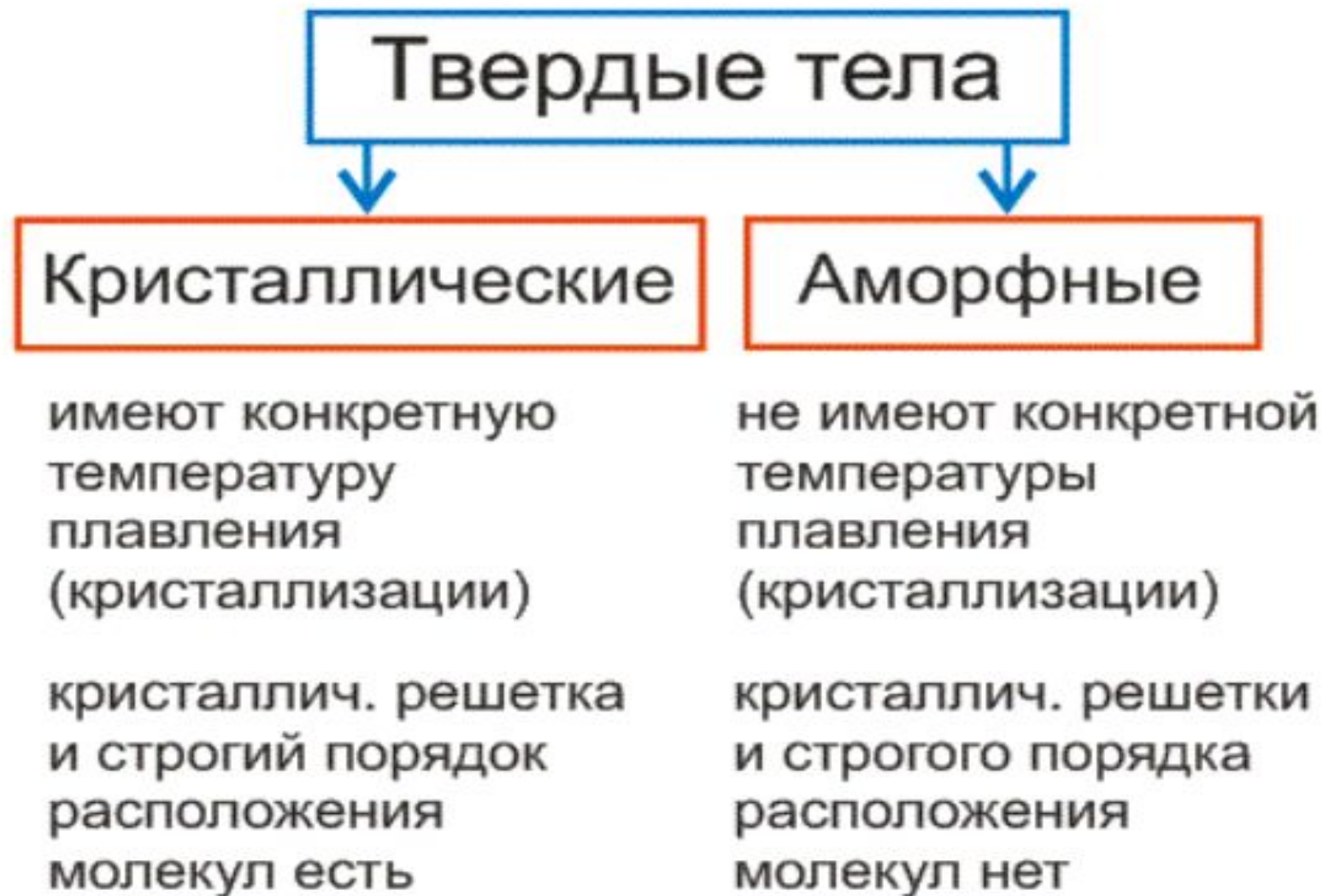
Рис. 2. Сравниваем свойства кристаллических и аморфных тел
