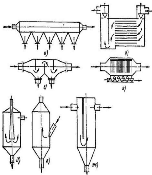
Осаждение пыли под действием сил тяжести осуществляется в аппаратах периодического и полунепрерывного действия, в которых происходит изменение направления и скорости потока газовзвеси.
