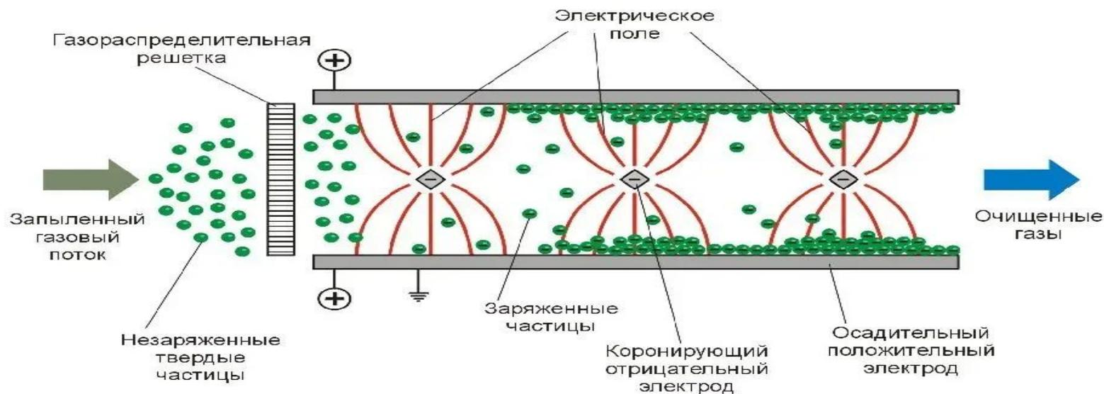
Процесс улавливания частиц в любых электрофильтрах имеет **три основные стадии** – 1) **зарядку взвешенных частиц**, 2) **осаждение заряженных частиц в электрическом поле** и 3) **удаление осажденного материала во внешний приемник**.
