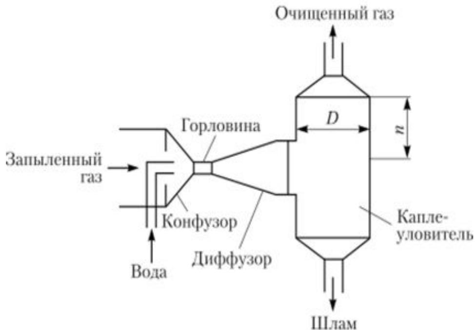
Здесь под действием центробежной силы капли жидкости с уловленными твердыми частицами отделяются от газа и в виде шлама сползают к коническому днищу к нижнему патрубку и выводятся через него. Очищенный газ выбрасывается в атмосферу. Степень очистки – 99%. Гидравлическое сопротивление очень велико – 2200...12800 Па.
