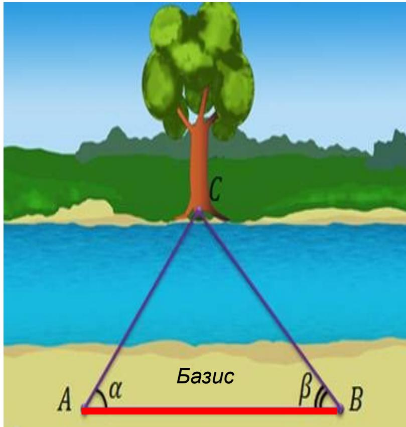
Способ, основанный на явлении параллактического смещения и предусматривающий вычисление расстояния на основе измерений длины одной из сторон (базиса – АВ) и двух углов А и В в треугольнике АСВ, применяется, если оказывается невозможным непосредственное измерение кратчайшего расстояния между пунктами.
