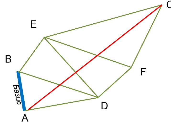
Для определения **длины дуги** используется система треугольников – **способ триангуляции**, который впервые был применен еще в 1615 г.
