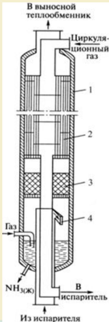
**Конденсационная колонна** — вертикальный цилиндрический аппарат внутренним диаметром 2 м и высотой 18,89 м. Число теплообменных трубок 7808, диаметр 14x2 мм, высота 7,21 м, поверхность теплообмена 2120 м<sup>2</sup> (по среднему диаметру). В межтрубном пространстве размещены перегородки. Охлаждаемый газ идет по межтрубному пространству, а газ после сепарации аммиака — по трубкам.
