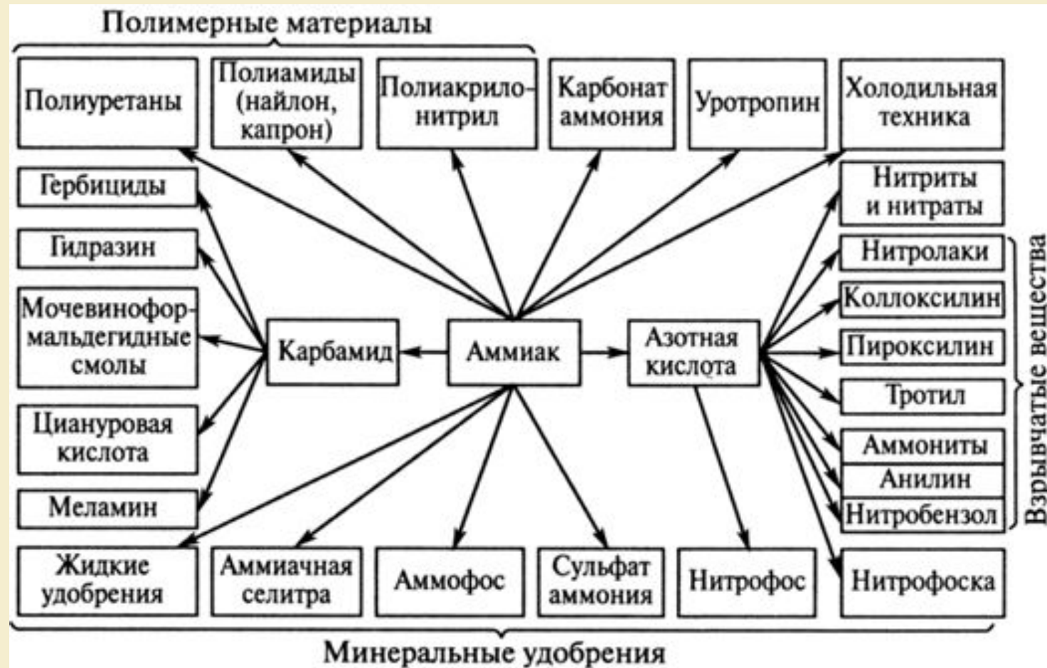
Рис. 6.1. Продукты, получаемые из аммиака, и области его применения.
