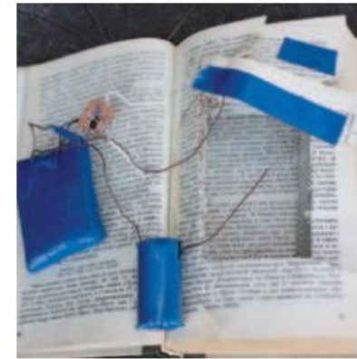
Спеціально встановлений вибухонебезпечний підрильний засіб, (міна-пастка) замаскований в банки з-під кави та книжку
