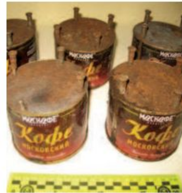
Спеціально встановлений вибухонебезпечний підрильний засіб, (міна-пастка) замаскований в банки з-під кави та книжку
