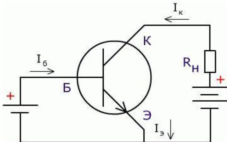
Схема включения биполярного транзистора с общим эмиттером
