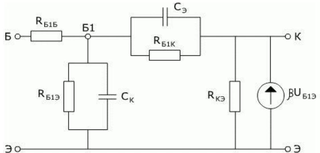
Гибридная  $\Pi$ -образная эквивалентная схема биполярного транзистора (включение с общим эмиттером) – схема Джиаколетто.
