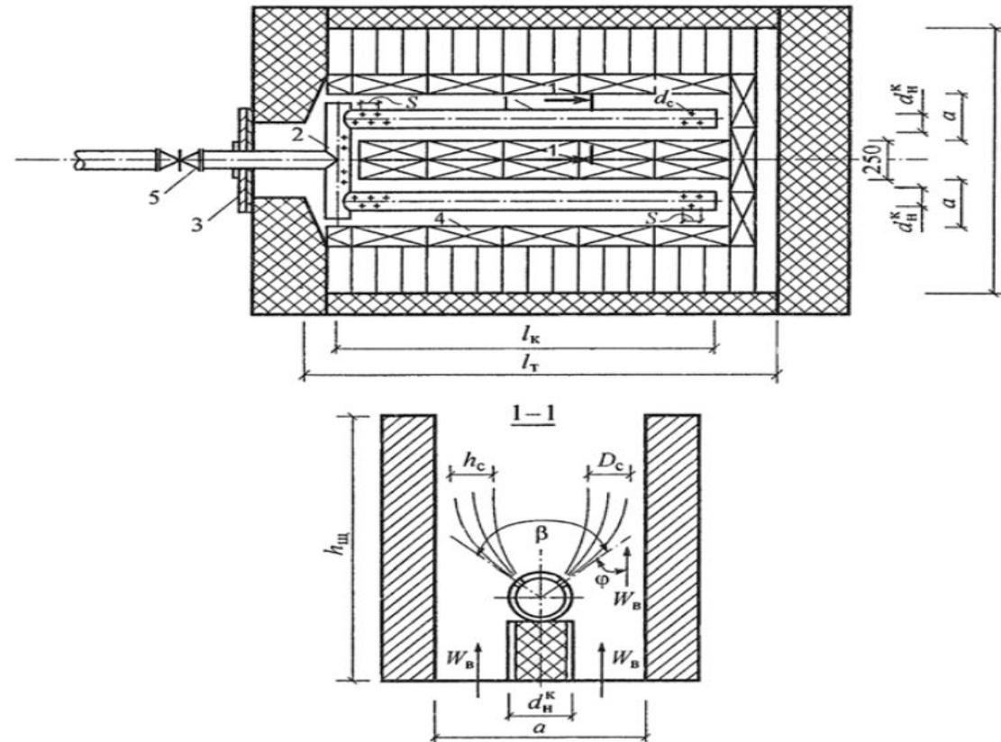
Рис. 2.1. Схемы размещения двухколлекторной подовой горелки в топке котла и коллектора в огневой щели:
