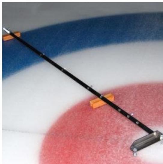
Циркуль-резак для создания разметки для керлинга
