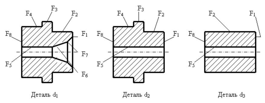
Рис. б. 1. Эскизы деталей для обработки на прутковом токарном автомате
