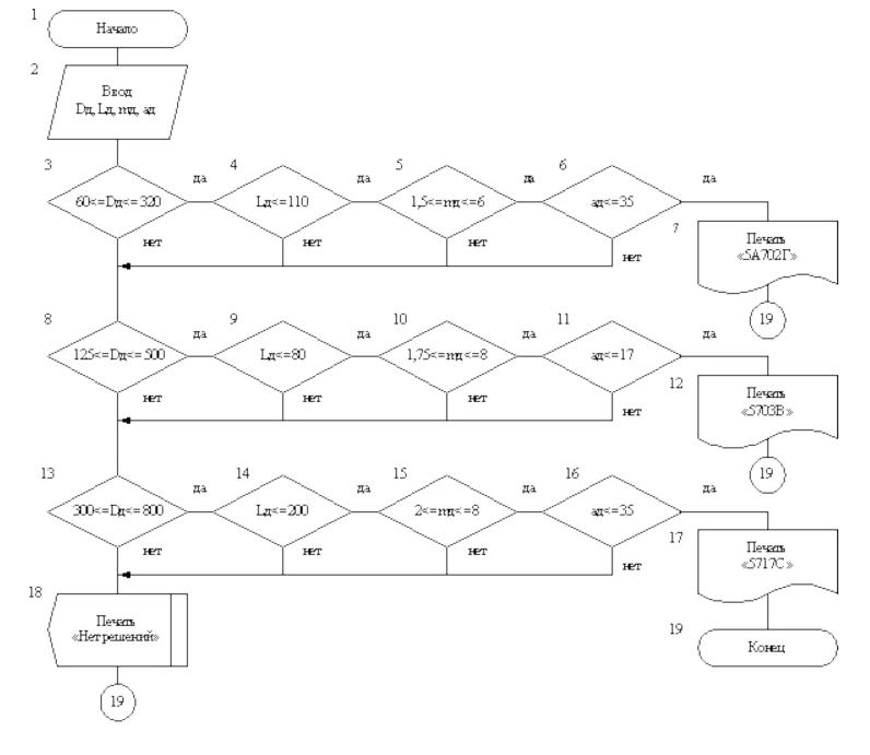
Рис. 7.1. Блок - схема алгоритма выбора модели зубощевинговального станка
