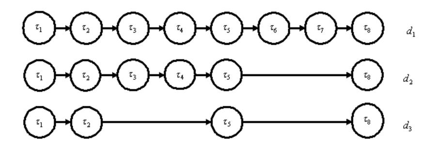
Рис. б. 2. Графы взаимосвязей переходов при обработке деталей  $d_1, d_2, d_3$
