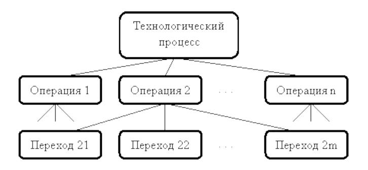
Рис. 5.1. Представление структуры технологического процесса в виде дерева
