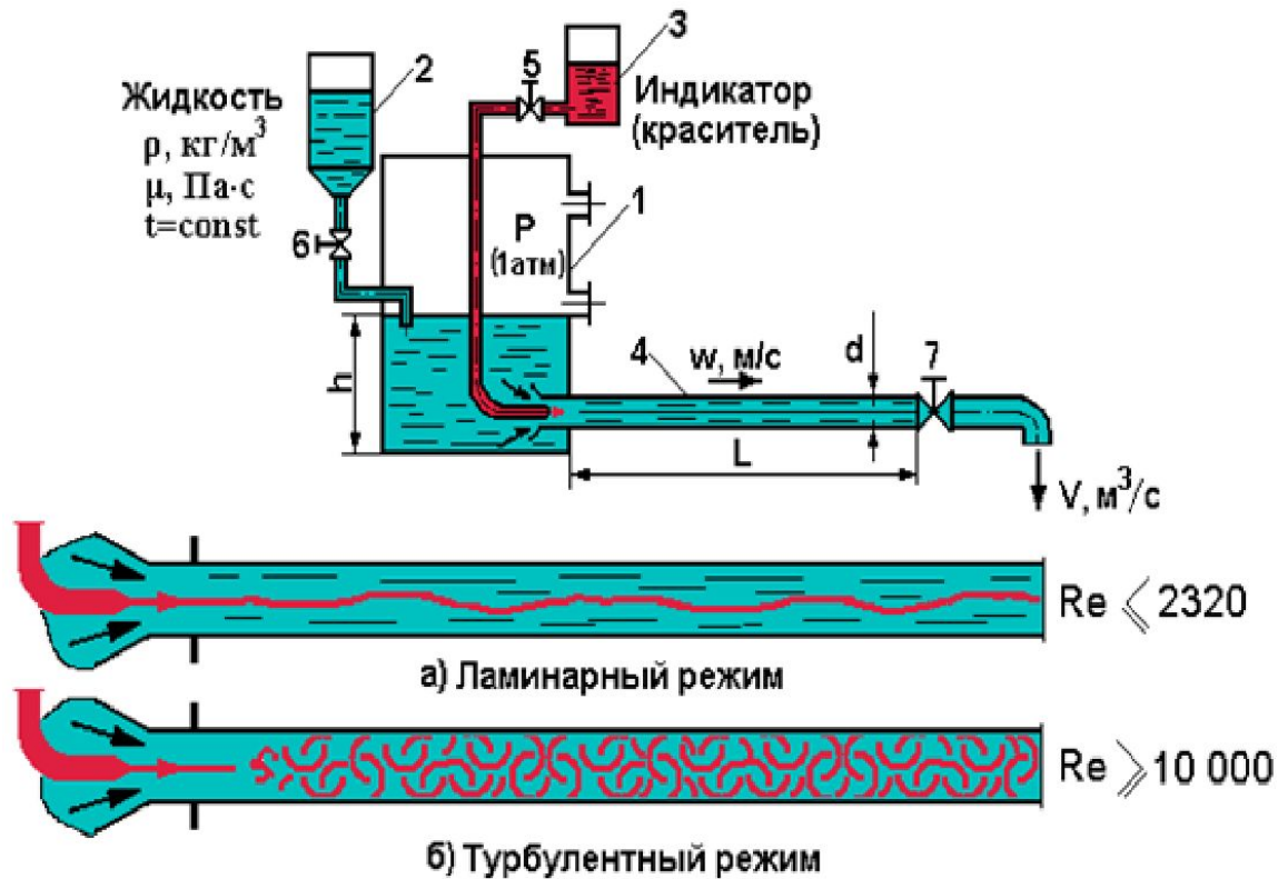
Рис. 1.7. Опыт Рейнольдса по определению гидродинамических режимов течения жидкостей
