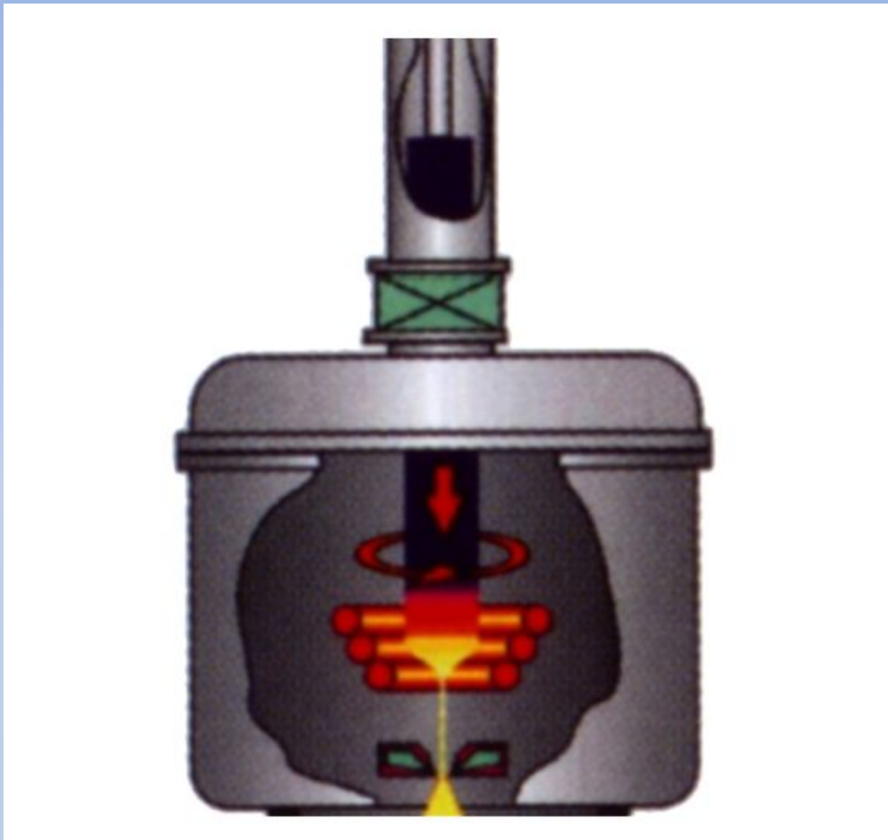
Процесс индукционной плавки электрода с распылением газом
