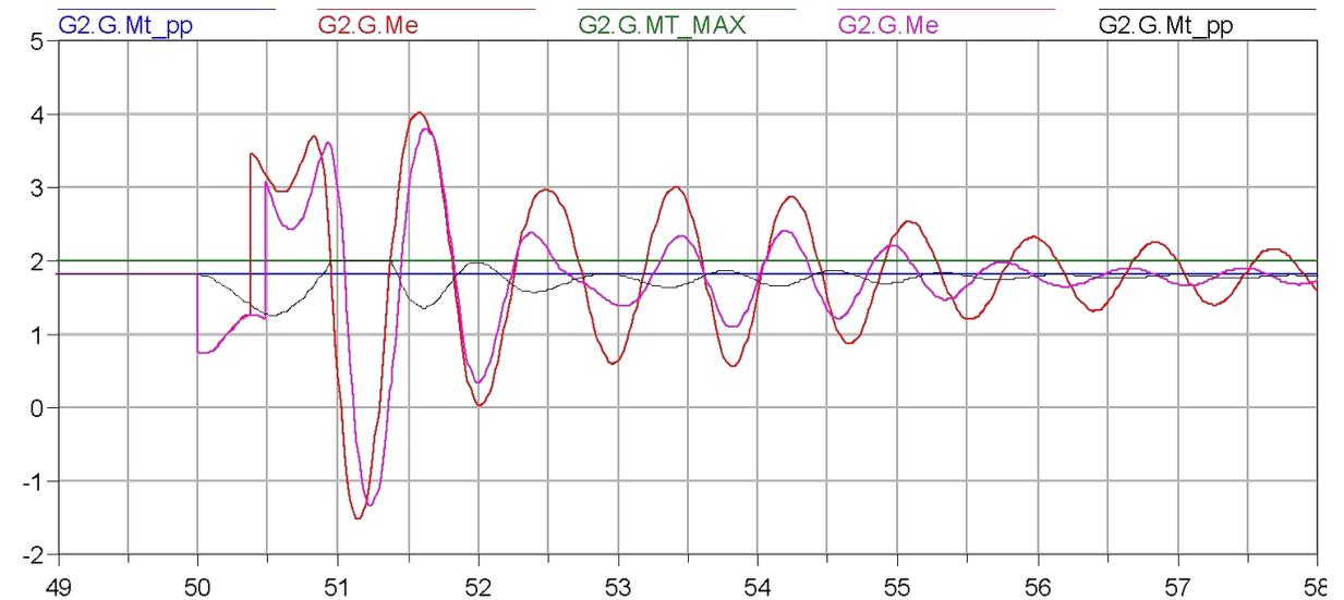
График зависимости взаимного ускорения Г2 относительно Г3 от взаимного угла для  $\Delta t_{кз} = 0,38$  (с) и  $\Delta t_{кз} = 0,48$  (с).
