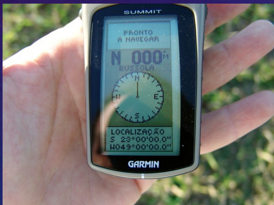
Электронный компас в системе GPS
