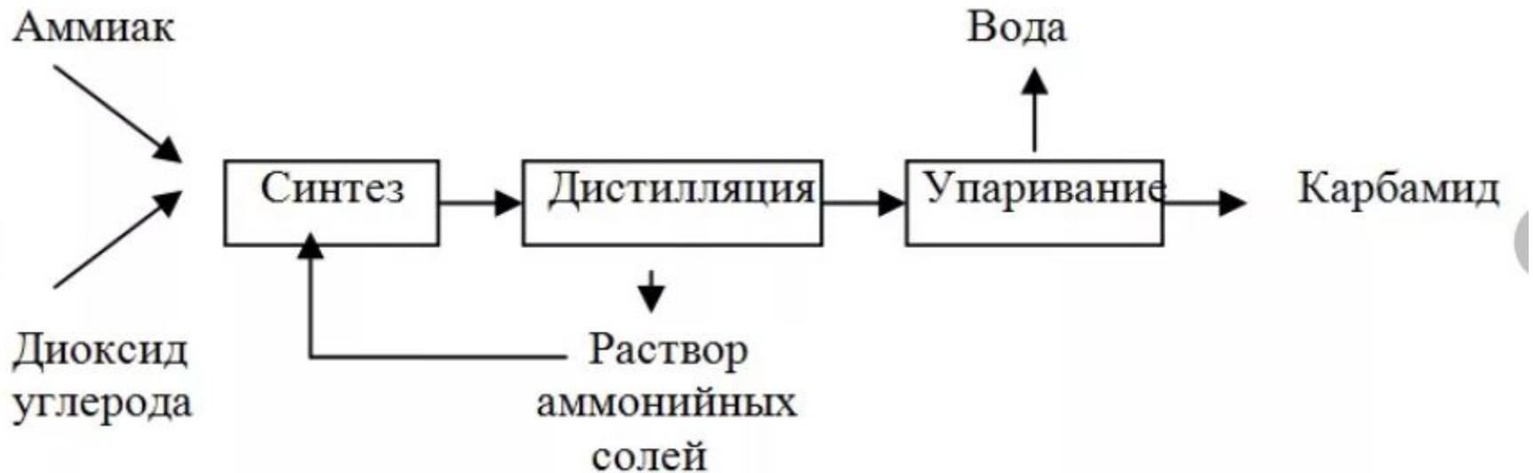
Аммиак и диоксид углерода превращаются в карбамид через карбамат аммония  $\text{NH}_2\text{COONH}_4$  при давлении около 140 бар и 180-185 °С. Конверсия аммиака достигает 41 %, углекислого газа – 60 %.
