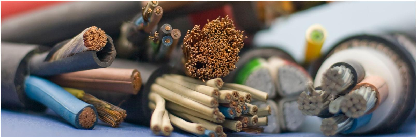
*Кабель (провод) - конструкция из одного или нескольких изолированных друг от друга проводников (жил), или оптических волокон, заключённых в оболочку. Кроме жил и изоляции кабель может содержать экран, наполнитель, броню, внешнюю оболочку. Каждый конструктивный элемент нужен для работоспособности кабеля в определённых условиях среды.*
