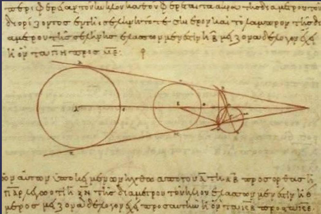
Схема, поясняющая определение радиуса Луны по методу
