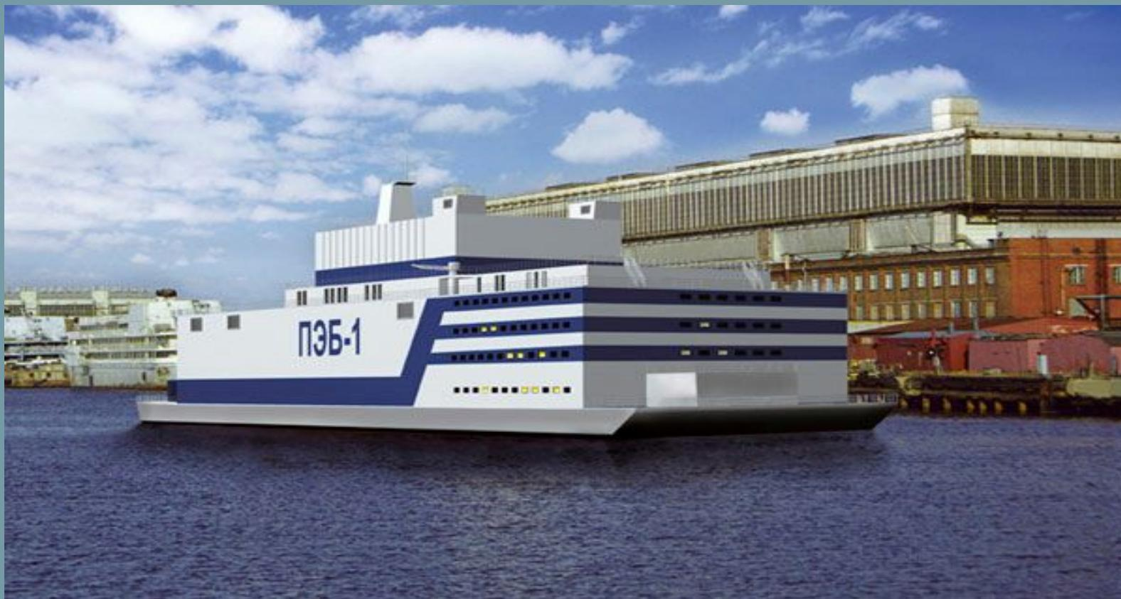
Пла́вучая станция может использоваться для получения **электрической и тепловой энергии**, а также **для опреснения морской воды**. В сутки она может выдать от 40 до 240 тысяч тонн пресной воды.
