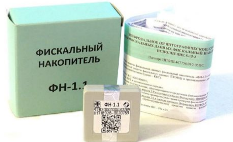
Габариты ФН: не более 30,2 x 30,2 x 9,4 мм (без ответной части разъёма).
