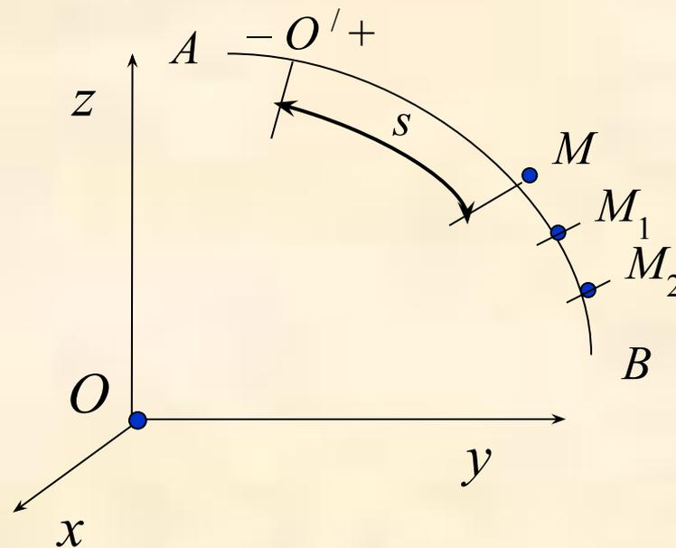
Примечание.  $O'M = s$  не является путем, пройденным точкой, а определяет положение точки на траектории, поэтому  $s$  часто называют *дуговой координатой*.
