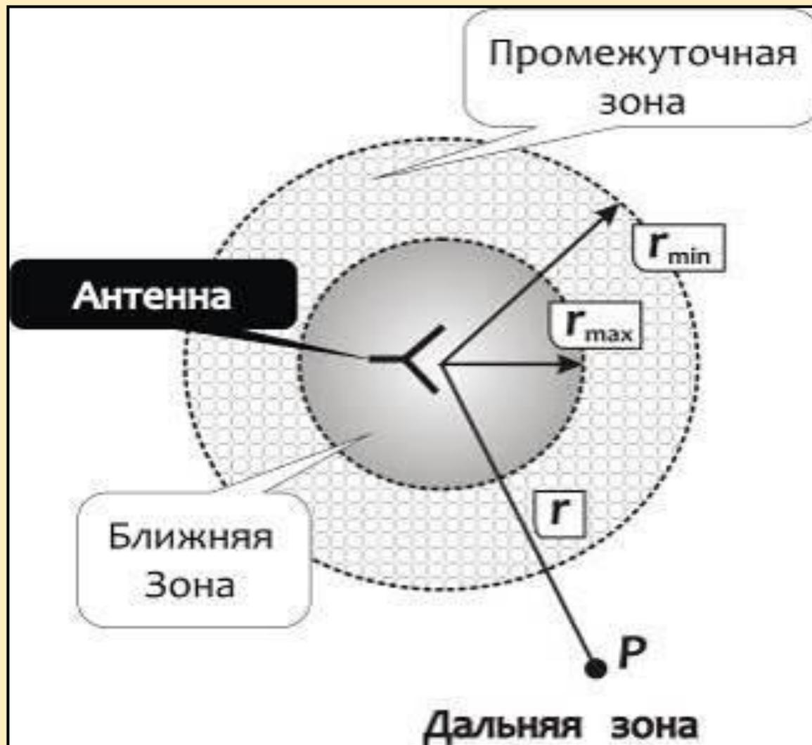
Основное отличие структуры поля в промежуточной зоне от поля в дальней зоне проявляется в том, что на монотонное убывание поля по закону  $1/r$  накладывается осциллирующее амплитудное затухание, а угловая зависимость поля оказывается зависящей от  $r$ , т.е. ДН в промежуточной зоне искажается. В ближней зоне поля имеют как поперечные, так и продольные составляющие векторов  $\vec{E}$  и  $\vec{H}$ , зависимость от расстояния  $r$  носит здесь нерегулярный характер.
