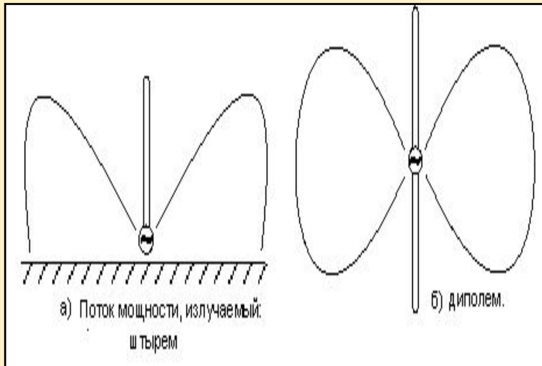
Коэффициент направленного действия (коэффициент усиления) НВ в два раза больше, чем у эквивалентного СВ, так как при одинаковой мощности излучения первый обеспечивает в два раза большую плотность мощности, так как вся его мощность излучается в одно полупространство.
