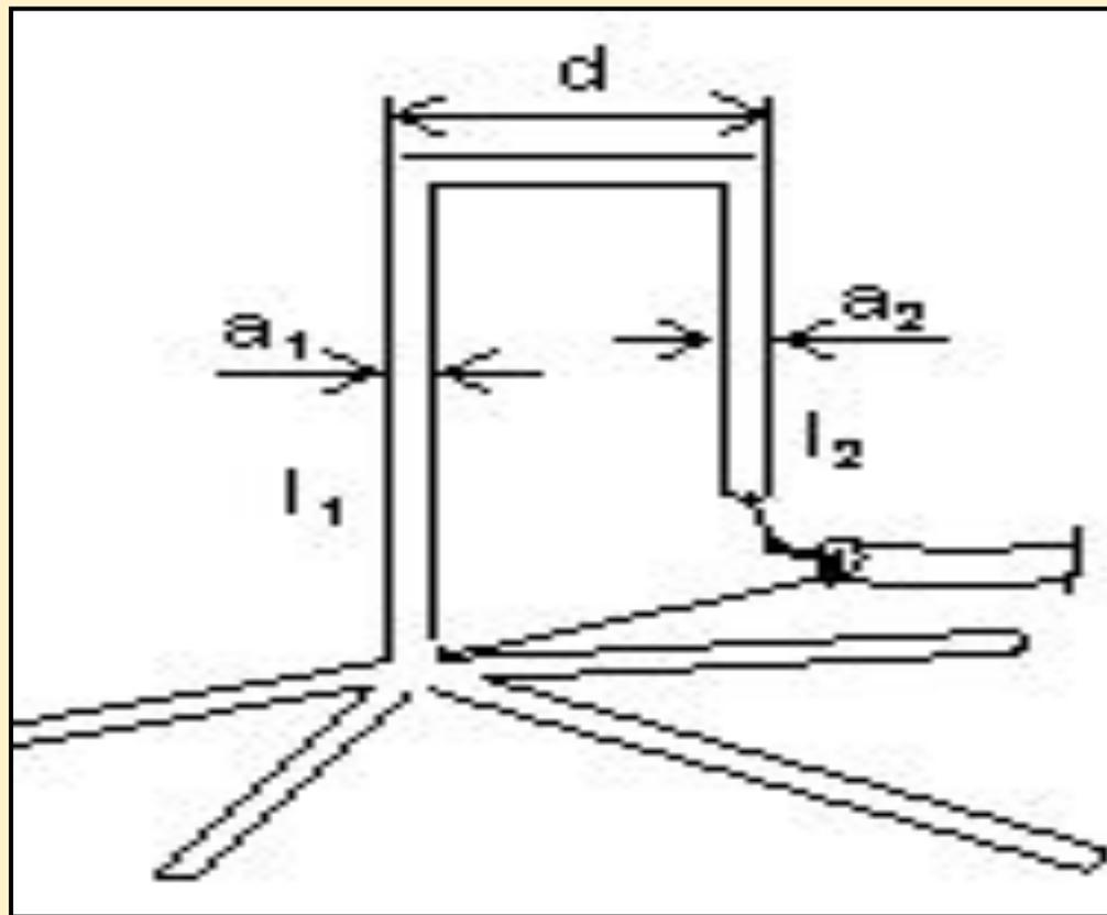
**Широкодиапазонные несимметричные вибраторы** могут быть коническими, ромбическими, цилиндрическими, сплошными и решетчатыми. Перекрытие диапазона рабочих частот зависит от отношения  $d//$ . Чем оно больше, тем широкополоснее вибратор.
