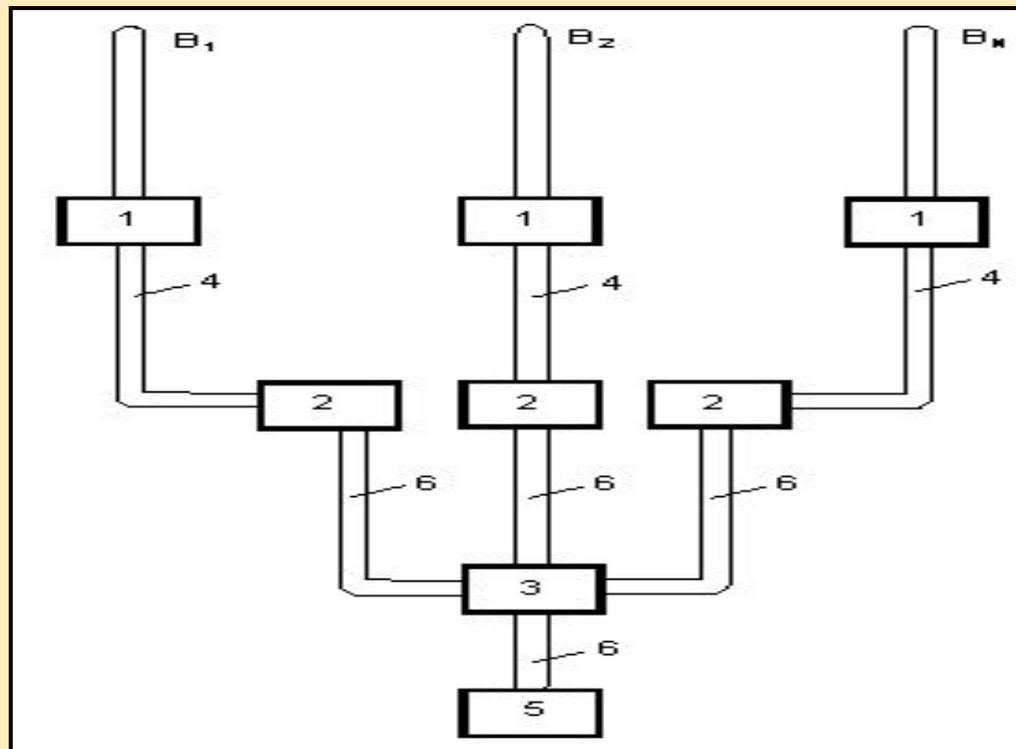
**Широкополосная фазированная вертикальная антенна с регулируемой ДН.** В фазированной направленной антенне все ее элементы запитываются от общего генератора с некоторым сдвигом фаз.
