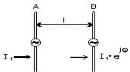
Д.Н. вертикальных вибраторов в горизонтальной плоскости
