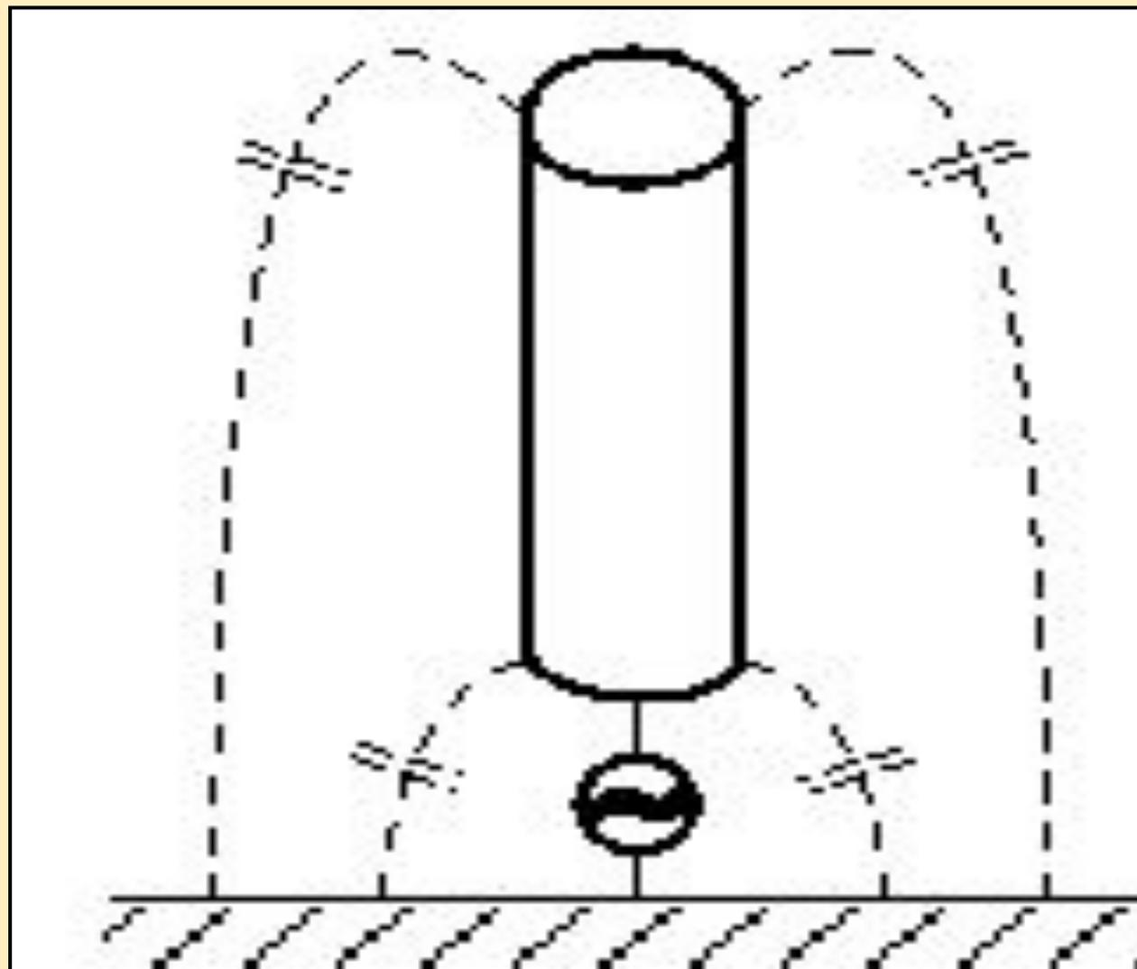
**ДН штыревых антенн, расположенных на земле и над землей.** Распределение токов не зависит от высоты подвеса при наличии системы противовесов.
