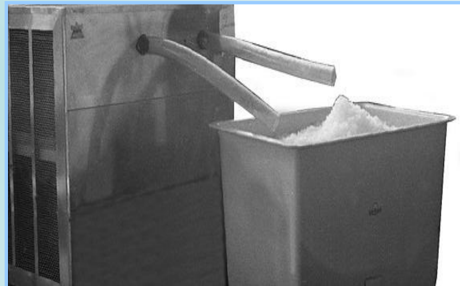
Получение чешуйчатого льда на барабане с горизонтальной осью
